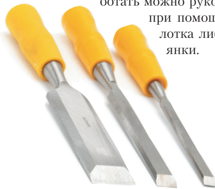
Рис. 2.15. Стамески с различной шириной режущей кромки
