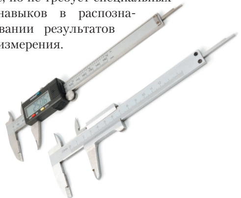
Рис. 2.18. Механический и цифровой штангенциркули
