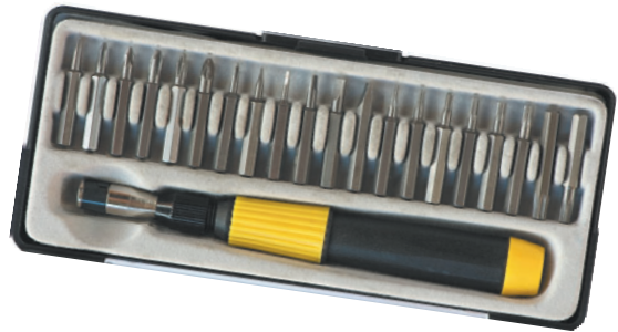
Рис. 2.7. Универсальная отвертка со сменными насадками на магнитном держателе
